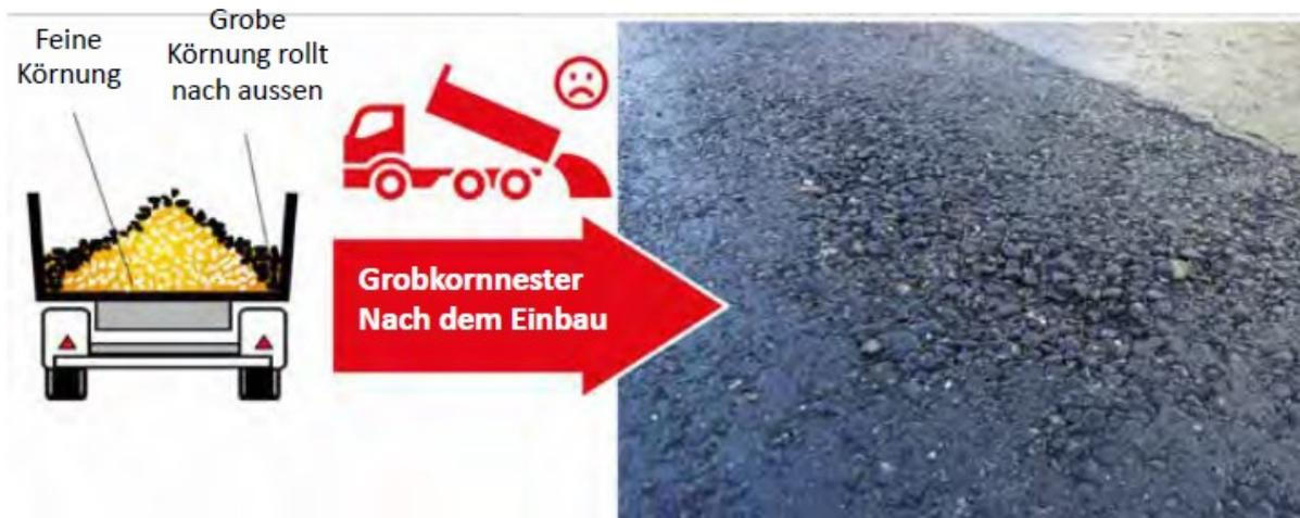
Abbildung 1: Grobkorn rollt nach außen – Grobkorn rutscht als erstes ab → dadurch treten meist intervallmäßig Grobkornnester auf.
