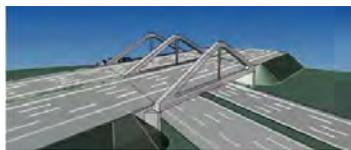
Sprengwerk mit vertikalem Zugseil / -stab
