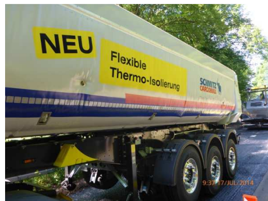
Foto 3 und 4: Einbaugeräte Walze, Fertiger mit Beschicker und Thermotransportmulde
