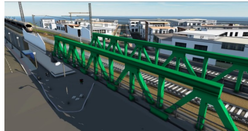
BIM-Modell einer Eisenbahnüberführung
