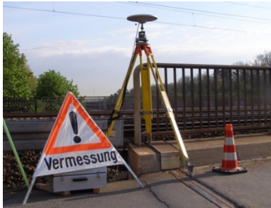
GNSS-Empfänger über einem Festpunkt
